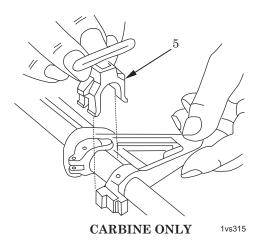
Figure 4. Removing Swivel Mount.
